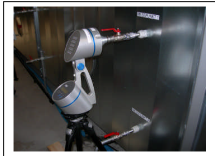
Abbildung 2: Messanordnung mit MAS-100
