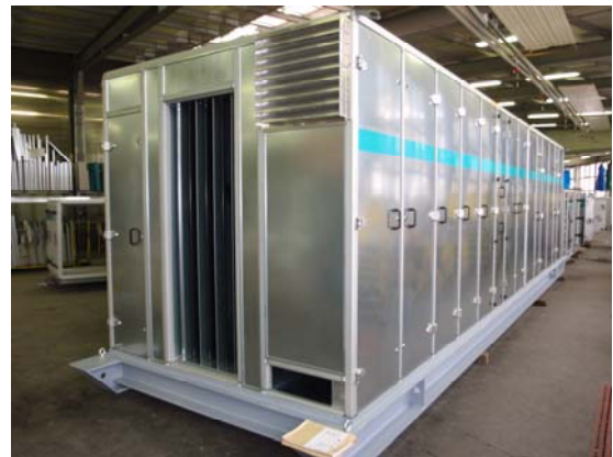
Kraftwerk Linth, 3 x 60 000 m 3 /h, je 1500 kW (Elektro)
